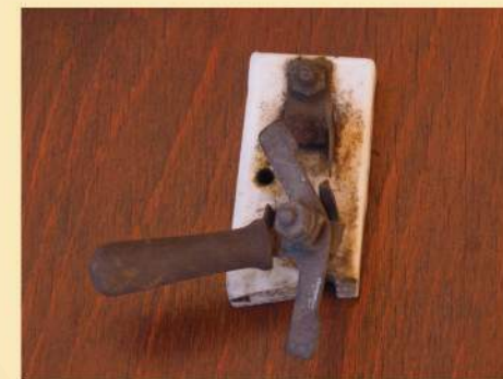
Dobový pákový přepínač, jenž byl součástí elektroinstalace
