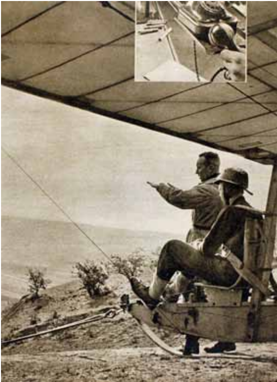
Německý instruktor ukazuje žáku na SG 38 techniku letu, vepředu je vidět napnutá guma (Adler, 21.10.1941, s. 661)
