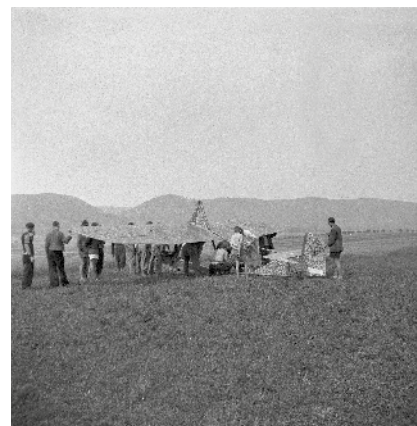
Na sestaveném kluzáku se před prvními vzlety kontrolují výztužná lanka. Jsme v Ořechách
